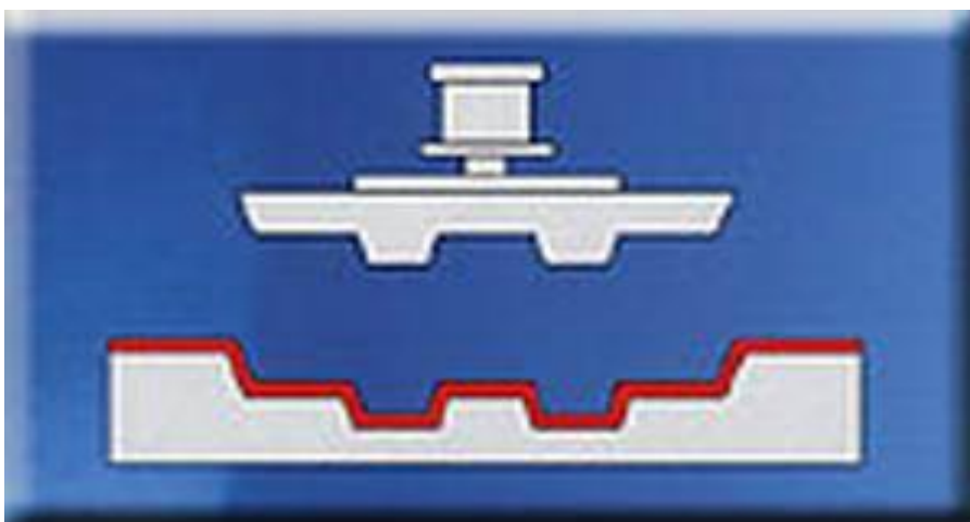
Парақ сызбасы бар матрицаға пневмоформалау схемасы
